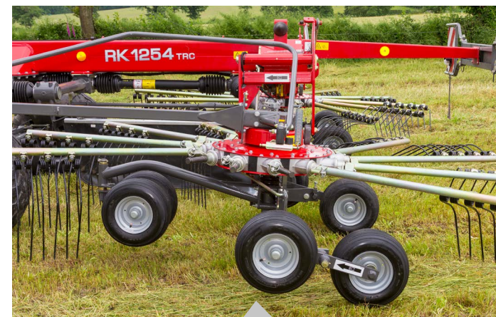
Запатентована карданна підвіска ротора
